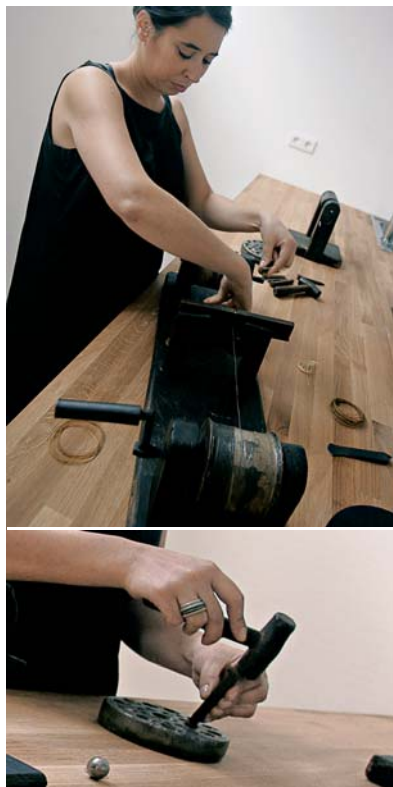
NO CARRINHO DE PUXAR FIO, A FILIGRANA PASSA PELO RUBI E FICA CADA VEZ MAIS FINA. AS CONTAS DE VIANA SÃO EXECUTADAS COM EMBUTIDOR E MARTELO. LILIANA USA-O PARA FAZER O SEU ANEL DE ESFERAS (PÁG. AO LADO)
