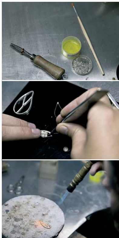
INSTRUMENTO PARA ENROLAR O FIO DE FILIGRANA E PÓ DE SOLDA. FEITAS AS ESPIRAIS COM O FIO, ESTAS SÃO CUIDADOSAMENTE ENCAIXADAS UMA A UMA NA SECÇÃO DA JÓIA. NO FIM, SOLDA-SE COM O MAÇARICO
